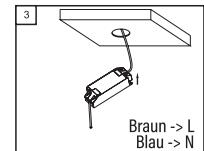
**Schritt 3 -** Schließen Sie die Phase und den Nullleiter an die L- und N-Seite des Treibers an. (ist auf dem Treiber/Trafo angegeben).
