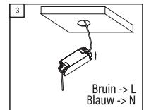
**Stap 3 -** Sluit de fase- en nuldraad aan, aan de L en N kant van driver. (staat op de driver/trafo aangegeven).
