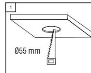
**Schritt 1 -** Ein Loch mit einem Durchmesser von 55 mm in die Decke machen.
