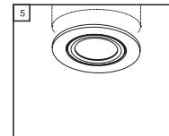
**Étape 5 -** Lorsque le spot encastré est placé correctement, celui-ci se clique au plafond/au cadre du système.
