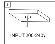
**Schritt 2 -** Vergewissern Sie sich, dass der Strom ausgeschaltet ist. Nehmen Sie die Phase und den Nullleiter an die L- und N-Seite des Treibers an. (ist auf dem Treiber/Trafo angegeben).
