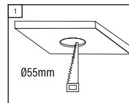
**Étape 1 -** Faites un trou dans le plafond d'un diamètre de 55 mm.
