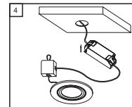
**Étape 4 -** Connectez les spots en série avec la boîte de distribution. Raccordez les boucles sur les connecteurs vides.
